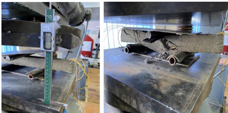
Рисунок 3- Проведение эксперимента по разрушению бетонной балки
